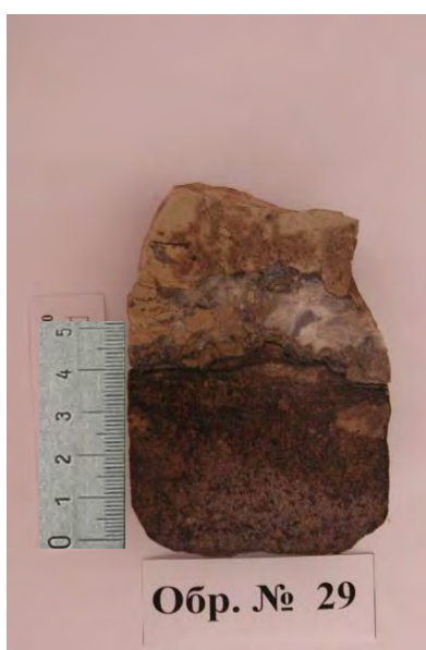
Рис. 4.6. Образцы керна каширского горизонта Шегурчинское месторождение. Скв. 1ш, пачка Скш-1. Известняк органогенно-обломочный (обр. №12 - тип коллектора - каверново-поровый, пористость 12,4 %, проницаемость 6,7 \cdot 10^{-3} \text{ мкм}^2 , остаточная водонасыщенность – 32%). Известняк доломитизированный пятнисто нефтенасыщенный (обр. № 20, тип коллектора - трещинно-поровый, пористость 7,9 %, проницаемость 1,06 \cdot 10^{-3} \text{ мкм}^2 , остаточная водонасыщенность – 54%). Контакт по стилолиту нефтенасыщенного органогенно-обломочного известняка и известняка пятнисто нефтенасыщенного, доломитизированного, трещинноватого, сульфатизированного (обр. № 29, тип коллектора – поровый (нижняя часть), пористость (нижняя часть) – 12,3 %, проницаемость 15,03 \cdot 10^{-3} \text{ мкм}^2 остаточная водонасыщенность – 35%). Скв.6, пачка Скш-1. Известняк органогенно-обломочный нефтенасыщенный, обр. №25, тип коллектора – каверново-поровый, пористость – 16,5%, проницаемость 195 \cdot 10^{-3} \text{ мкм}^2 , остаточная водонасыщенность –22%.
