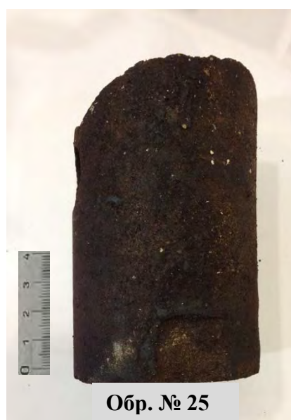
Рис. 4.6. Образцы керна каширского горизонта Шегурчинское месторождение. Скв. 1ш, пачка Скш-1. Известняк органогенно-обломочный (обр. №12 - тип коллектора - каверново-поровый, пористость 12,4 %, проницаемость 6,7 \cdot 10^{-3} \text{ мкм}^2 , остаточная водонасыщенность – 32%). Известняк доломитизированный пятнисто нефтенасыщенный (обр. № 20, тип коллектора - трещинно-поровый, пористость 7,9 %, проницаемость 1,06 \cdot 10^{-3} \text{ мкм}^2 , остаточная водонасыщенность – 54%). Контакт по стилолиту нефтенасыщенного органогенно-обломочного известняка и известняка пятнисто нефтенасыщенного, доломитизированного, трещинноватого, сульфатизированного (обр. № 29, тип коллектора – поровый (нижняя часть), пористость (нижняя часть) – 12,3 %, проницаемость 15,03 \cdot 10^{-3} \text{ мкм}^2 остаточная водонасыщенность – 35%). Скв.6, пачка Скш-1. Известняк органогенно-обломочный нефтенасыщенный, обр. №25, тип коллектора – каверново-поровый, пористость – 16,5%, проницаемость 195 \cdot 10^{-3} \text{ мкм}^2 , остаточная водонасыщенность –22%.
