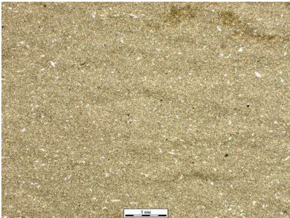
Рисунок 2.23 - Доломит микрокристаллический Трещины, раскрытостью до 0,03 мм. Без анализатора.
