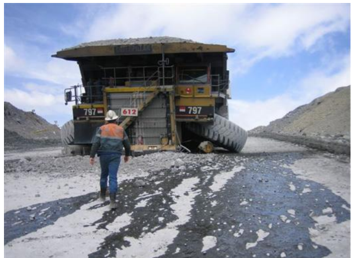
Повреждение грузовика из-за плохого проектирования съезда, вызывающего нагрузку на рулевую раму и оси
