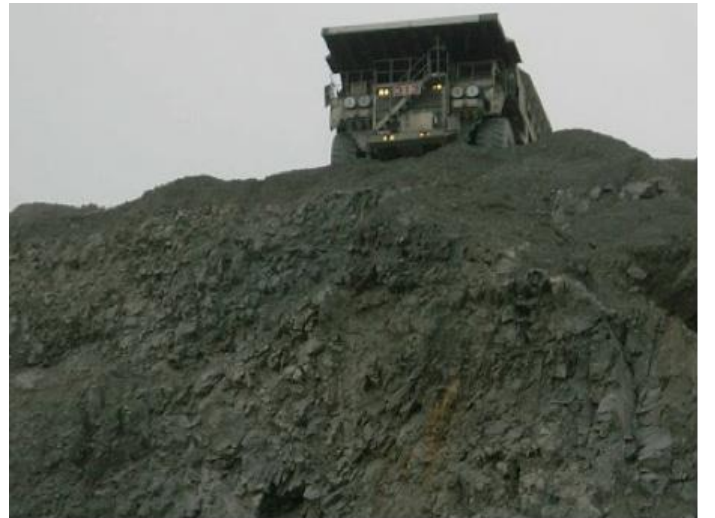
Повреждение грузовика из-за плохого проектирования съезда, вызывающего нагрузку на рулевую раму и оси
