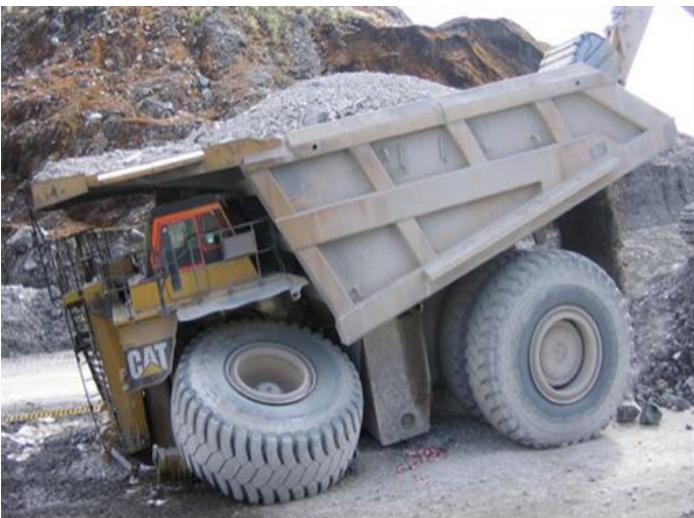
Повреждение грузовика из-за плохого проектирования съезда, вызывающего нагрузку на рулевую раму и оси
