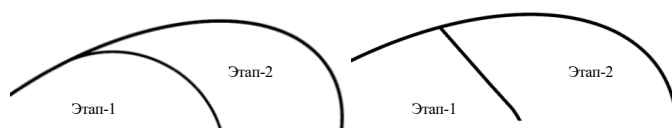
Рисунок 12 Небезопасное пересечение фаз (слева) и безопасное пересечение фаз (справа)
