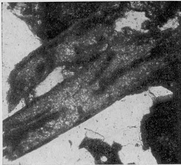
Рис. 3. Кристалл вольфрамитa, частично замещенный ферритунгситом. Без анализатора. Увел. 48
