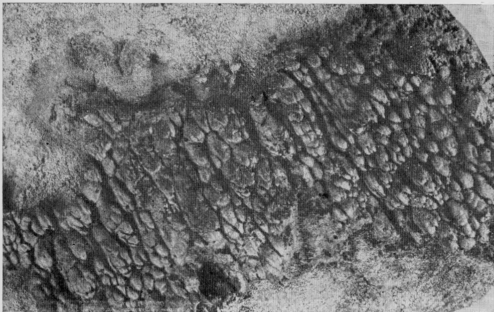
Рис. 7. Асимметрично-почковидные образования геля сульфида железа на поверхности пиритовой коры. Каптажный колодец скв. У-1. Период образования 2,5 месяца. Natur. вел.
