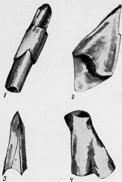
Рис. 1. Различные типы короткостолбчатых и конических зерен. Зарисовки по микрофотографиям
