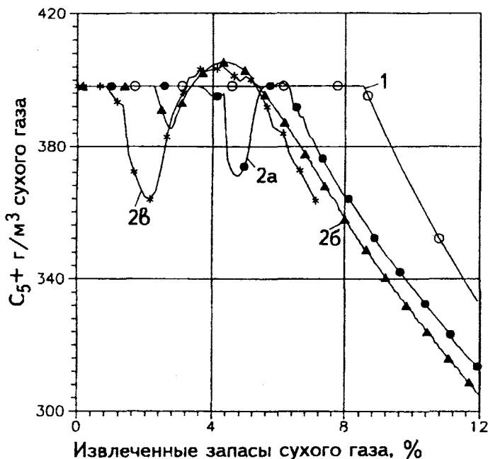
Рис. 10.1. Зависимости содержания C_5 в добываемом газе от степени извлечения запасов сухого газа для недонасыщенной газоконденсатной системы. 1 - дифференциальная конденсация; 2 - фильтрация с дебитом, тыс. m^3/сут : а - 150, б - 200, в - 250
