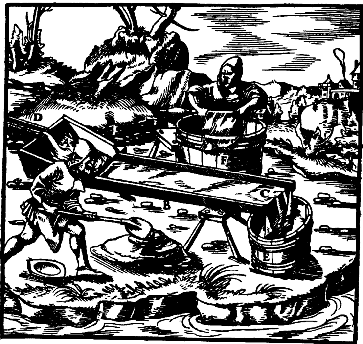
Рис. 18. Промывка породы на вашгерде, застланном сукном [Агрикола Георгий. О горном деле и металлургии в двенадцати книгах (главах). М., Недра, 1986]
