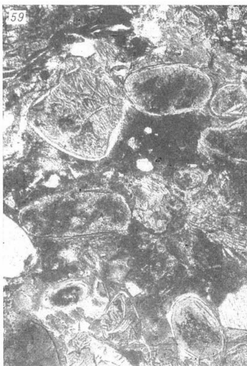
Рис. 59. Аутигенные оолиты и оонды гидрогетито-хлоритового состава, сцементированные хлоритом. Верхний горизонт, скв. 10-к, обр. 256. Проходящий свет. \times 100 .
