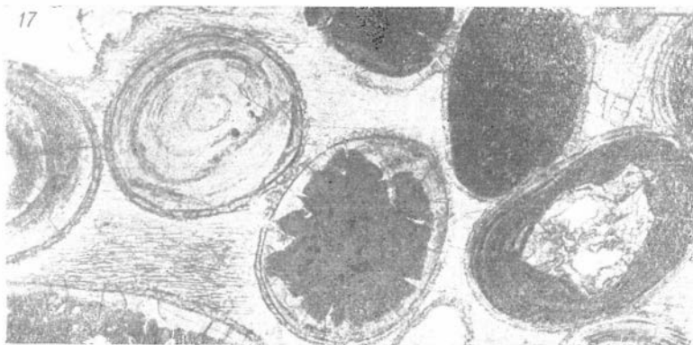
Рис. 17. Вивианит, пойкилитовые кристаллы. Бакчарский горизонт, скв. 9-к, обр. 121. Проходящий свет. \times 40 .
