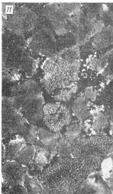
Рис. 12. Скелетные формы вторичных гидроокислов железа (светлые), развивающихся на глауконите. Верхний горизонт, отраженный свет. \times 40 .
