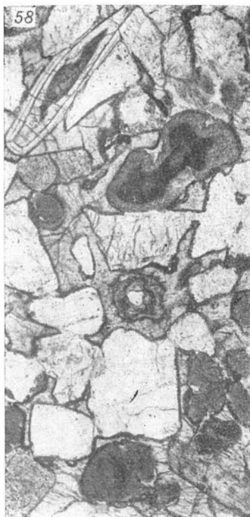
Рис. 58. Аутигенный глауконит в песчанике. Зона выклинивания верхнего горизонта, скв. 54, обр. 549. Проходящий свет. \times 40 .
