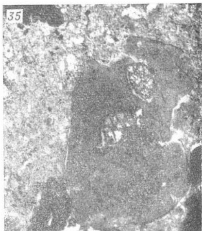
Рис. 35. Глаукогнито-глинистая порода. Видны зерна с включениями терригенных частиц. Славгородская свита, скв. 7-я, обр. 209. Проходящий свет. \times 100 .
