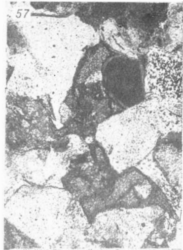
Рис. 57. Песчаник с редкими зернами глауконита и корково-поровым хлорито-сидеритовым цементом. Верхний горизонт, зона выклинивания, скв. 10, обр. 614. Проходящий свет. \times 100 .
