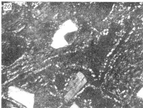
Рис. 20. Корки франколита в конкреции, Славгородская свита, скв. 1-к, обр. 19. Проходящий свет. \times 100 .
