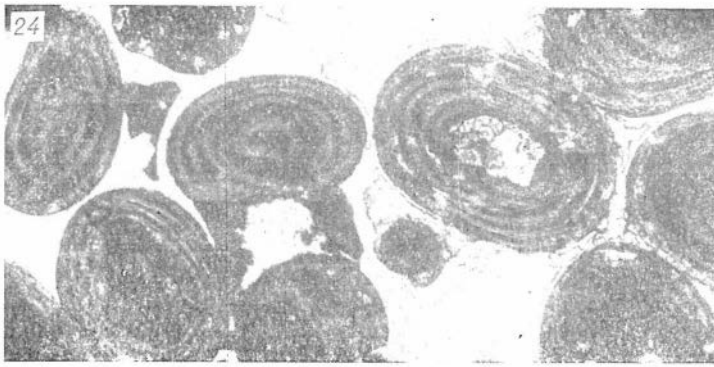
Рис. 24. Корково-поровый хлоритовый цемент в сыпучей руде. В центре пор видны реликты нераскристаллизованного хлорита (темного) и местами сидерита. Верхний горизонт, скв. 41, обр. 602. Проходящий свет. \times 100 .
