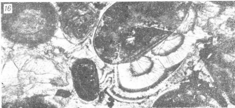
Рис. 16. Сферолитовый зональный колломорфный сидерит. В центре пор виден пирит. Верхний горизонт, скв. 55, обр. 739. Проходящий свет. \times 60 .
