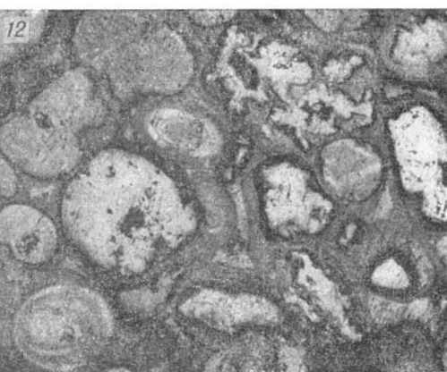
Рис. 12. Скелетные формы вторичных гидроокислов железа (светлые), развивающихся на глауконите. Верхний горизонт, отраженный свет. \times 40 .
