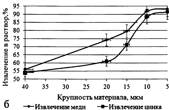
Рисунок 7.19. Зависимости (а) степени окисления сульфидов и (б) извлечения цветных металлов в раствор автоклавного окисления при различной крупности материала
