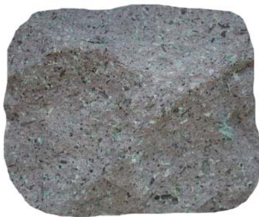
◀ Рис. 81. Андезит. Темная розовато-бурая порода с порфировыми включениями плагиоклазов и роговой обманки. Пустоты в породе выполнены хлоритом. Натуральная величина
