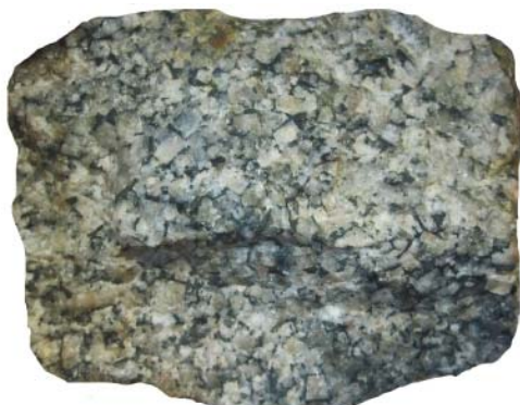
➤ Рис. 20. Уртит. Массивная порода светло-серого цвета, состоящая из тол- сто-таблитчатых кристаллов нефелина и эгирина (черное). Натуральная величина
