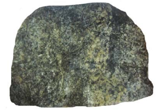
◀ Рис. 18. Ийолит полевошпатовый. Серо-зеленоватая среднезернистая массивная порода, состоящая из нефелина с клинопироксеном и щелочного полевого шпата. В образце отмечается альбитизация (светлые области). Натуральная величина
