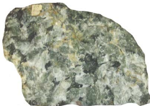
◀ Рис. 76. Хибинит. Крупнозернистая светло-серая массивная порода, сложенная ортоклазом, изометричными зернами нефелина, среди которых расположены черные обособления эгирина и редкие розовые зерна эвдиалита. Натуральная величина
