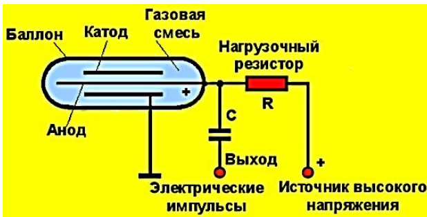
Рис. 3.5. Схема включения цилиндрических счетчиков
