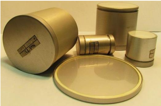
Рис. 3.10. Внешний вид сцинтиллятора (йодистый натрий, активированный галлием)
