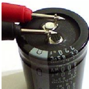
Рис. 1.9. Как необходимо прозванивать конденсатор
