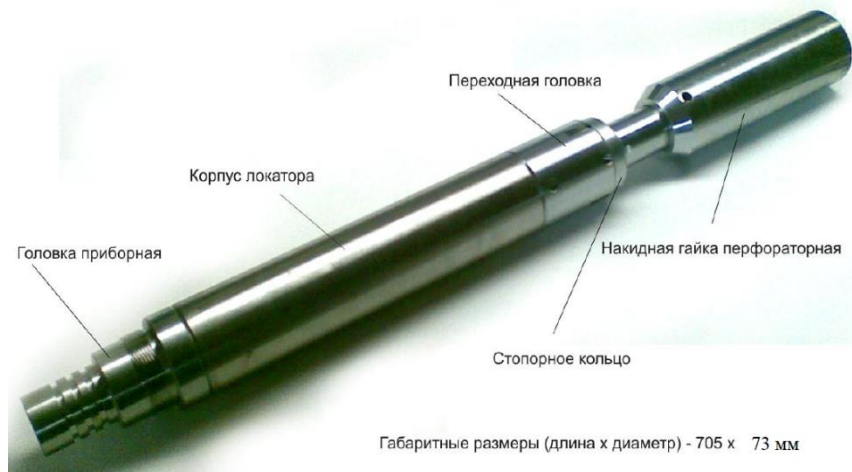
Рис. 10.5. Общий вид локатора муфт
