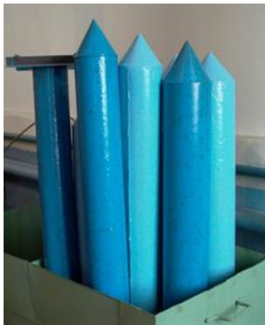
Рис. 11.7. Калибровка каналов аппаратуры нейтронного каротажа
