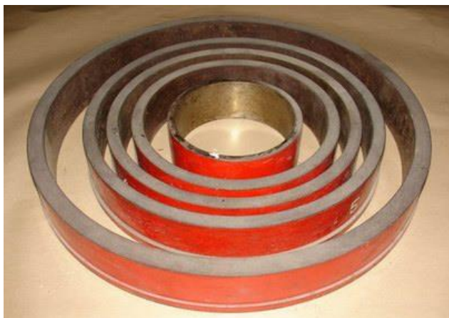
Рис. 11.3. Фото комплекта 5-ти эталонных колец для градуировки и калибровки каверномеров-профиломеров
