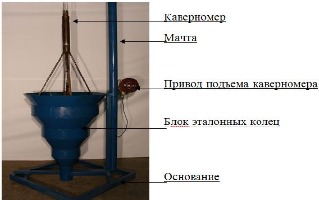
Рис. 11.4. Фото установки УАК-Кав-700 для автоматизированной калибровки каверномеров и профилемеров
