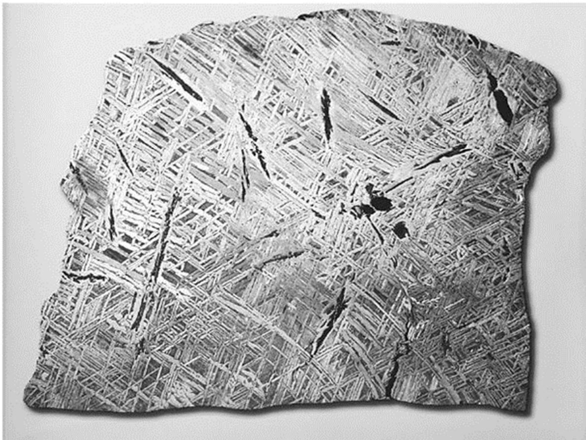
Видманштеттеновы фигуры на протравленной поверхности пластинки, выпиленной из железного метеорита
