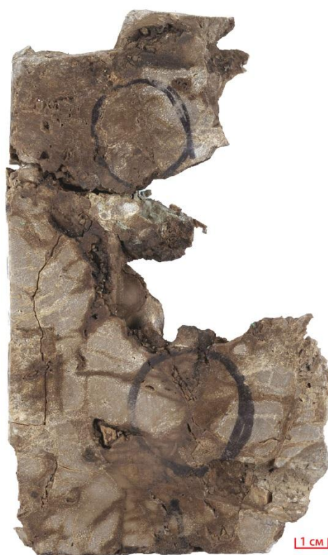
Рисунок 1 - Трещинно-кавернозный доломит по биогермному известняку.
