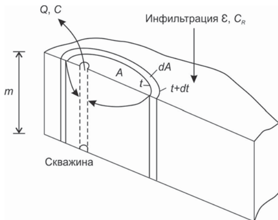
Рис. 2.6. Динамика зоны захвата при подтягивании частиц воды к водозаборной скважине.
