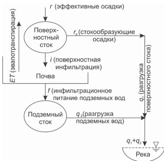
Рис. 18.9. Схематическое представление двухкомпонентной модели сосредоточенной емкости для поверхностного/подземного стока.
