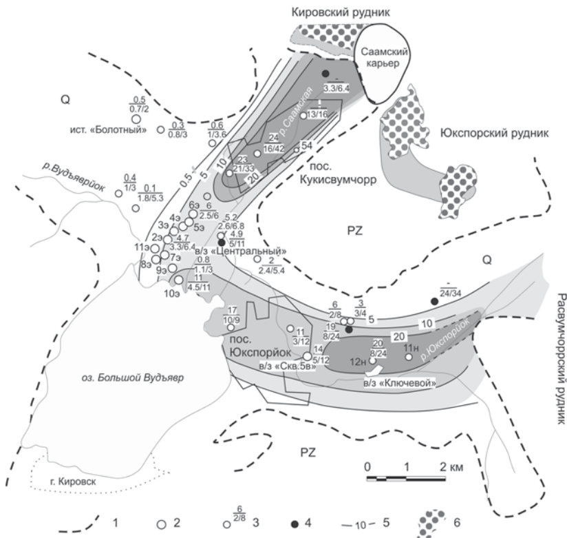
Рис. 7.6. Схема загрязнения подземных вод в бассейне оз. Большой Вудьяр (по данным опробования 1988 г.).
