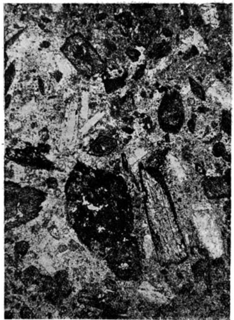
Фиг. 41. Пироксен-роговообманково-плагиоклазовый порфирит. Фенокристы пироксена, роговой обманки и плагиоклава. \times 25 . Простой свет (шл. № 574).
