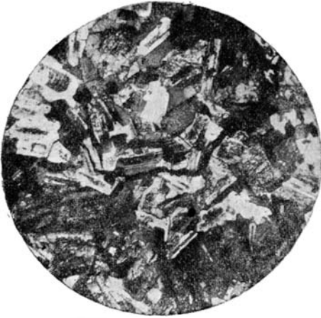
Фиг. 52. Жильный роговообманково-биотитовый монзонит. Общий характер структуры. Плагиоклаз и темноцветные сцементированы ортоклазом. \times 16 . Николи + (шл. № 427).
