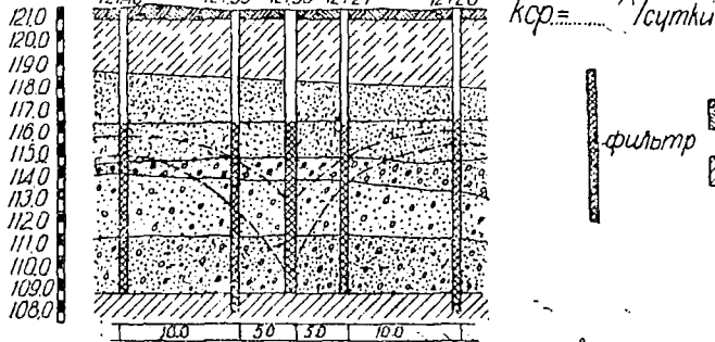
Рис. 12. Геологический разрез с кривыми депрессии и план с гидронзогеипсами при откачках.
