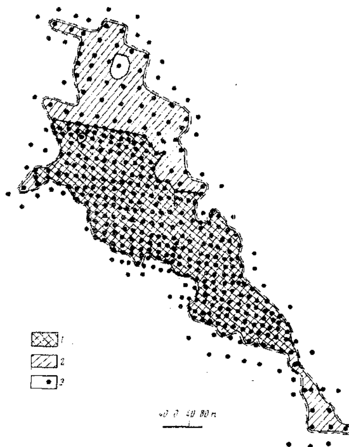
Рисунок 3 – План силикатно-никелевого месторождения Промежуточное к подсчету запасов руд. 1 – запасы, учтенные по категории В; 2 – запасы, учтенные по категории С 1 ; 3 – устья скважин.
