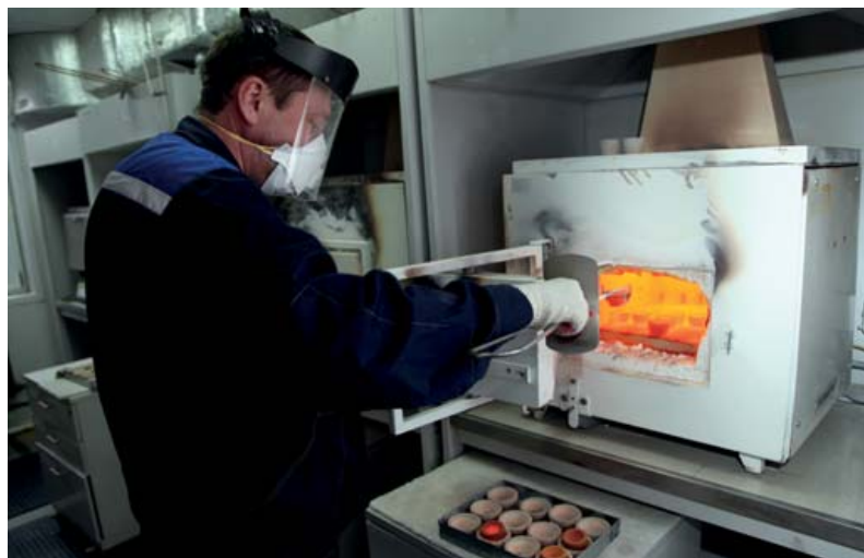
Ежемесячно в лаборатории анализируется до 200 проб пробирным и атомно-абсорбционным методами
