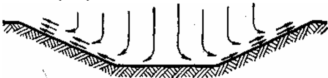
Рис. 19. Движение воздуха в карьере при конвективной схеме проветривания
