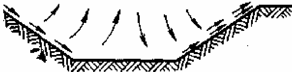
Рис. 20. Прямоточно-конвективная схема проветривания карьера
