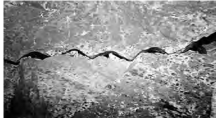
Рис. 13.5. Создание разгрузочной щели бурением параллельных шпуров: а — вид скважин сразу после бурения; б — скважины после разгрузки приконтурной области массива (Кировский рудник ОАО «Апатит»)
