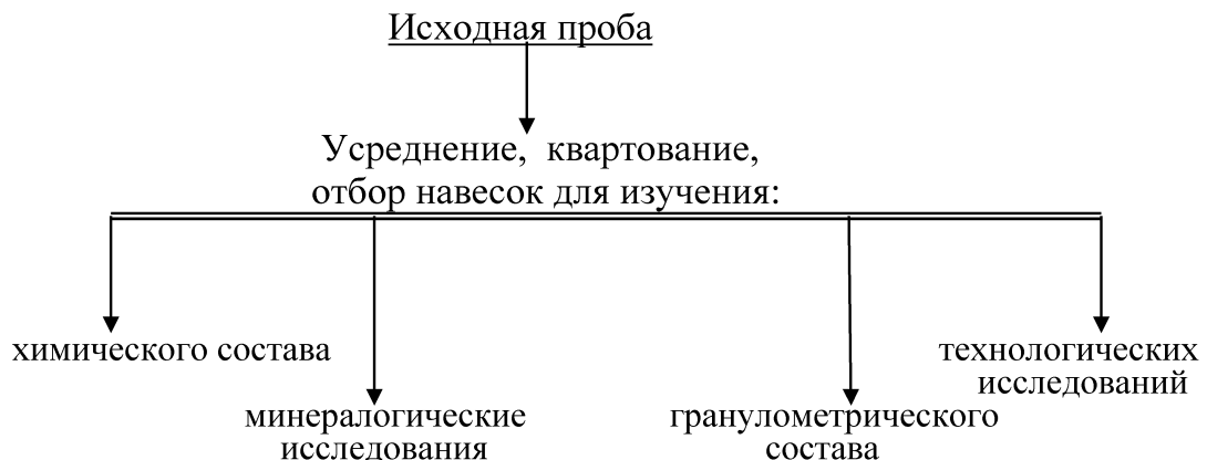
Рисунок 2.5 – Схема подготовки исходного материала к изучению вещественного состава и технологическим исследованиям
