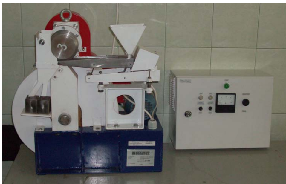
Рис. 5.2. Сепаратор электромагнитный валковый типа ЭВС-10/5
