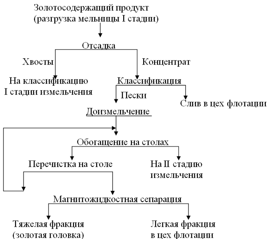
Рис. 8.1. Схема извлечения золота на золотоизвлекательной секции Зыряновской фабрики
