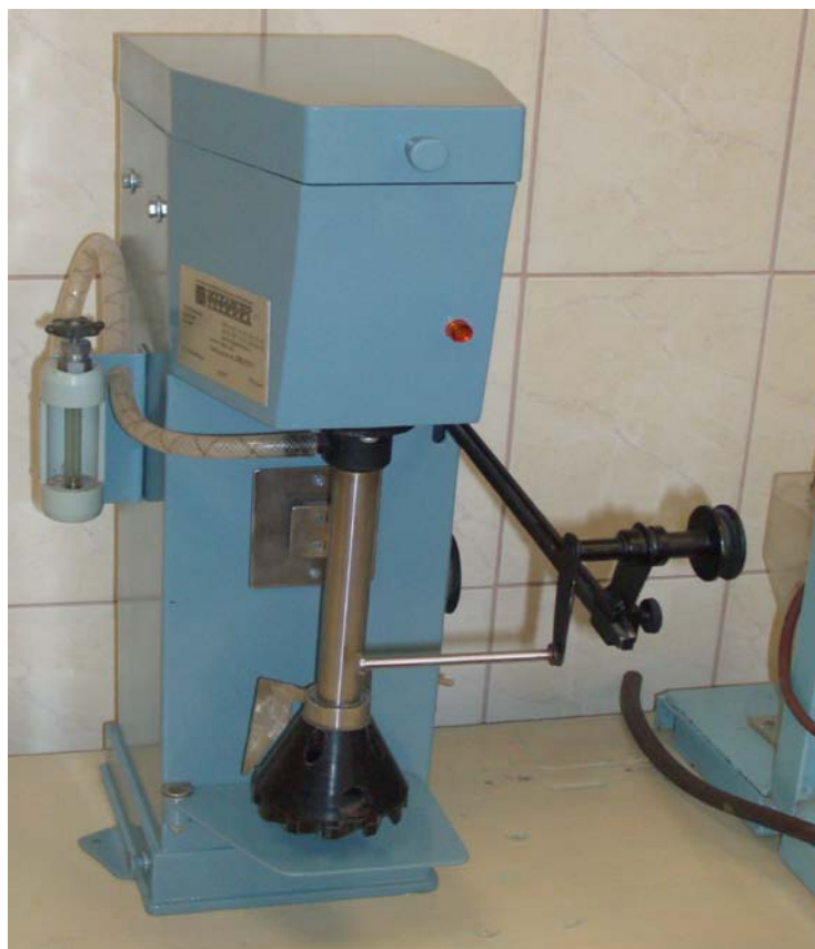
Рис. 1.1. Лабораторная механическая флотационная машина
