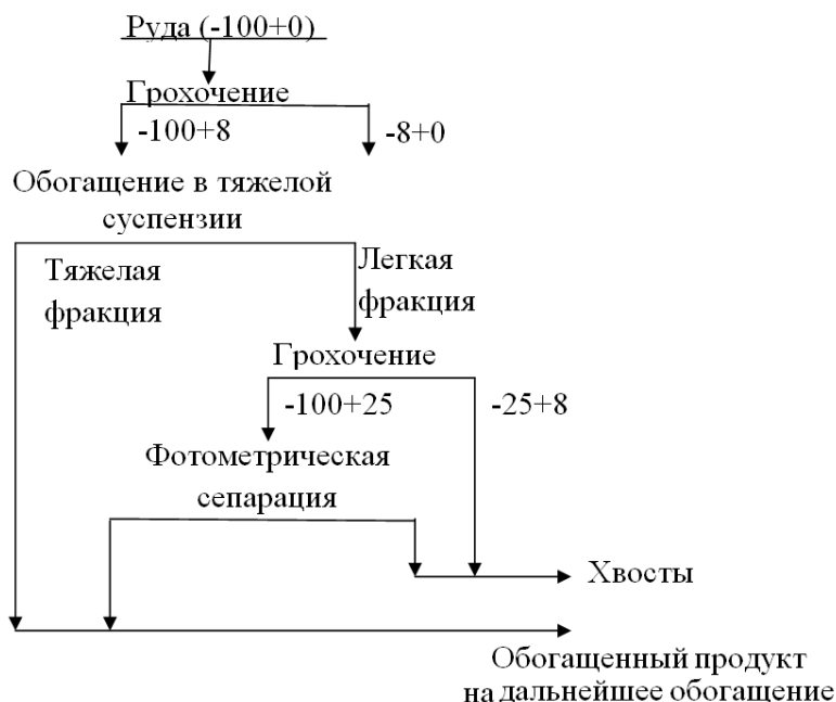
Рис. 20. Комбинированная схема предварительного обогащения оловосодержащей руды
