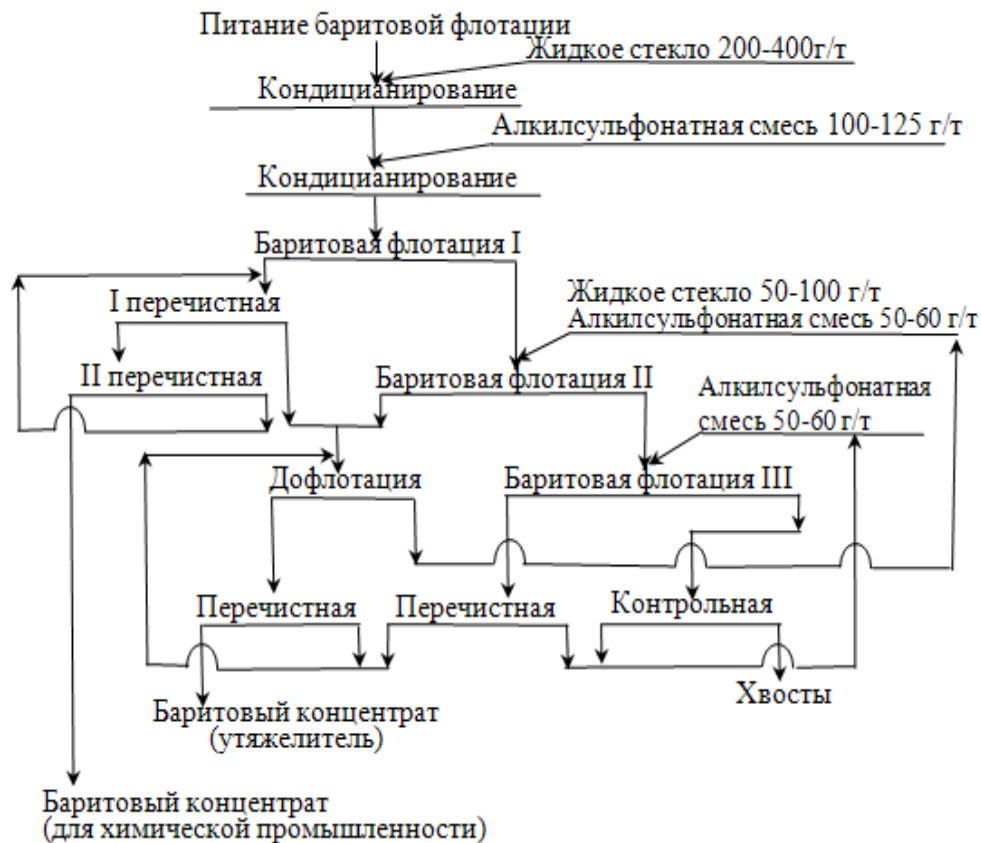
Рис. 45. Технологическая схема и режим баритовой флотации на Кентауской фабрике
