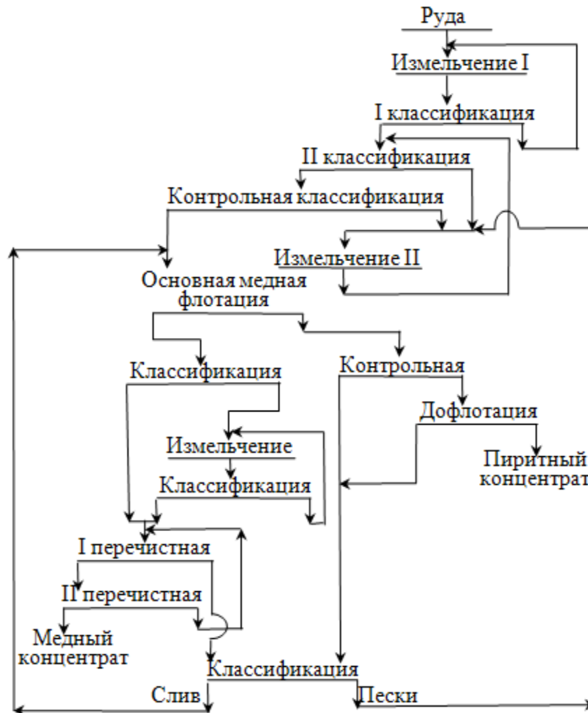
Рис. 30. Схема обогащения медных руд Гайского месторождения на Среднеуральской фабрике
