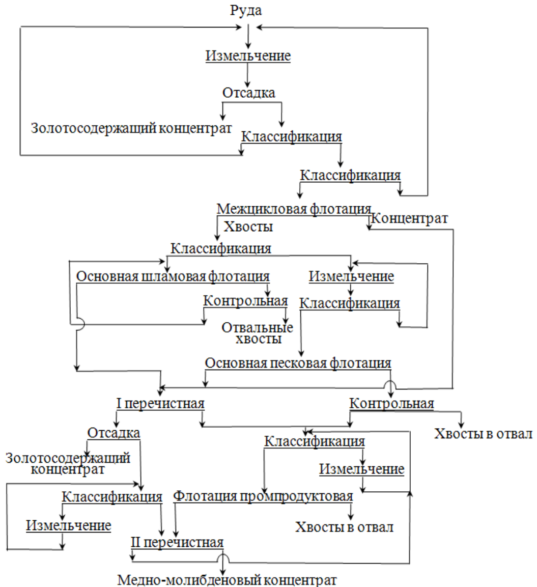
Рис. 27. Схема коллективной медно-молибденовой флотации на Алмалыкской медной фабрике
