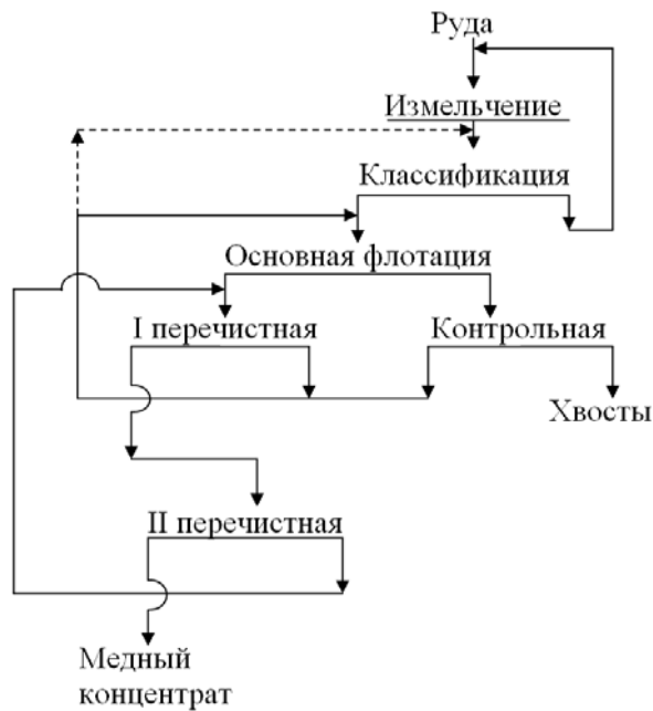
Рис. 24. Одностадиальная схема флотации медных руд
