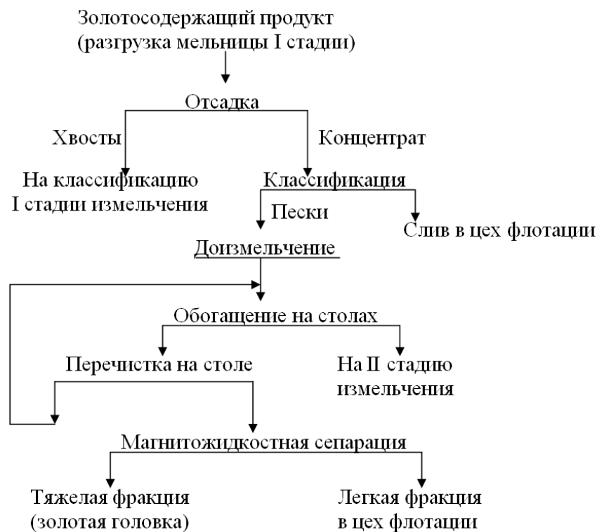
Рис. 44. Схема извлечения золота на золотоизвлекающей секции одной из фабрик
