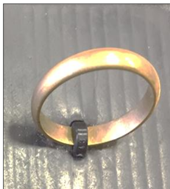
Рисунок 37. Обручальное кольцо полукруглого профиля (придание формы ручным способом)
