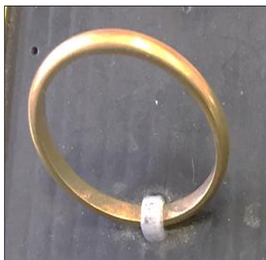
Рисунок 38. Обручальное кольцо полукруглого профиля (придание формы профиля с помощью вальцев)
