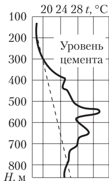
Рис. 9.29. Температурная кривая для определения высоты подъема цементного раствора за обсадной колонной
