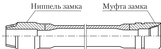
Рис. 5.3. Труба бурильная с приваренными замками
