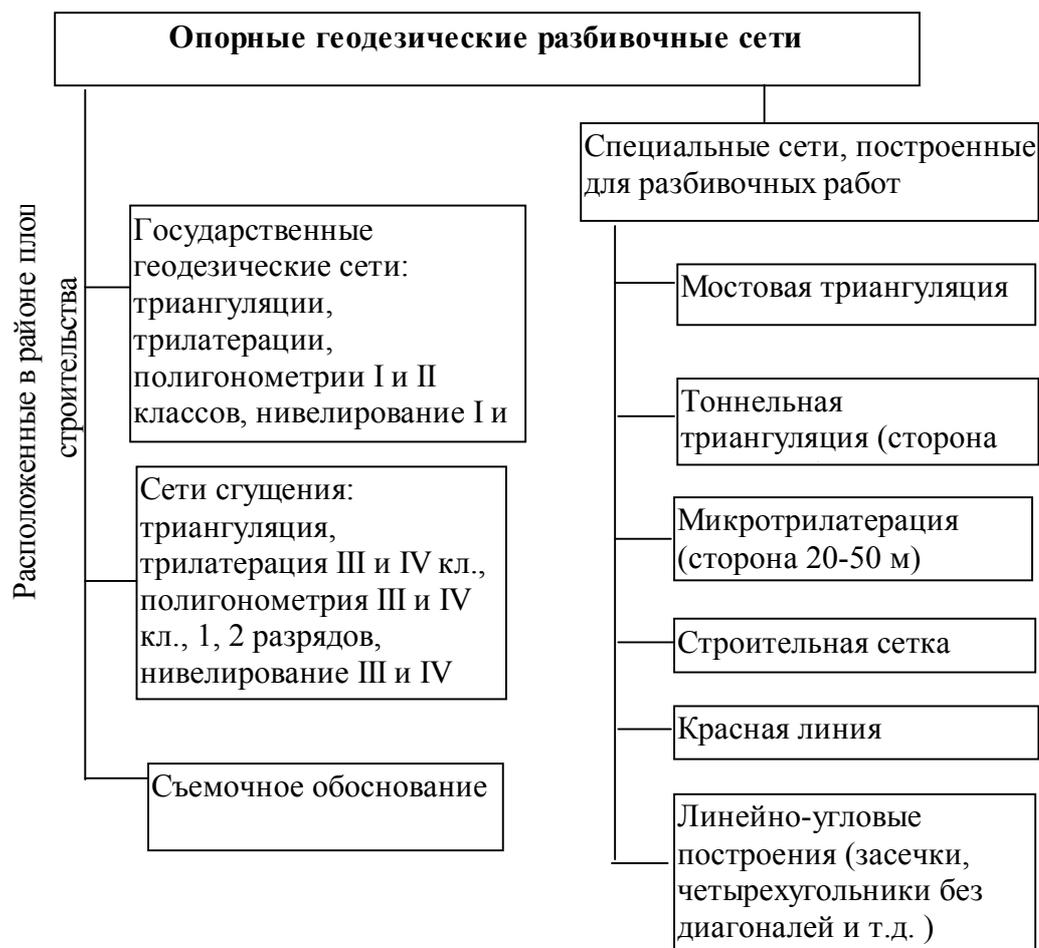
Рисунок 31 – Классификация опорных геодезических разбивочных сетей
