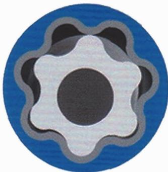
**Рис. 5.3. Статор и ротор винтового забойного двигателя с постоянной толщиной эластомера**
