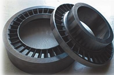
**Рис. 5.1. Ступень турбины турбобура (статор и ротор)**
