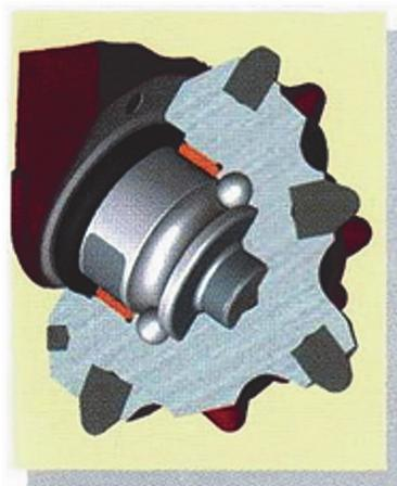
**Рис. 3.3. Герметизированная маслonaполненная опора
