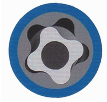
**Рис. 5.2. Статор и ротор винтового забойного двигателя (поперечный разрез)**
