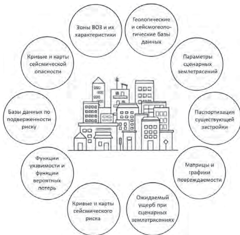
Рис. 4.8. Элементы вычислительного алгоритма сейсмического риска
