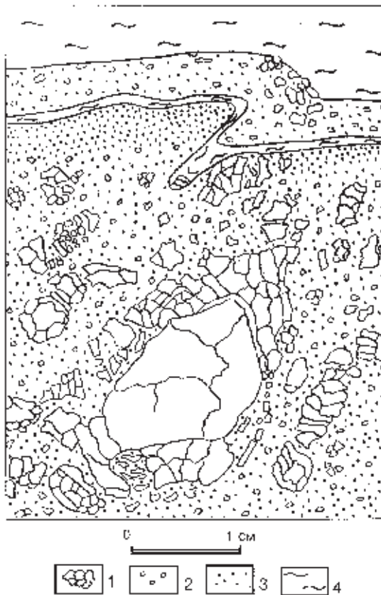
Рис. 57. Признаки растрескивания и рассыпания пиритовых рудокластов в кровле первой залежи Молодежного месторождения.
