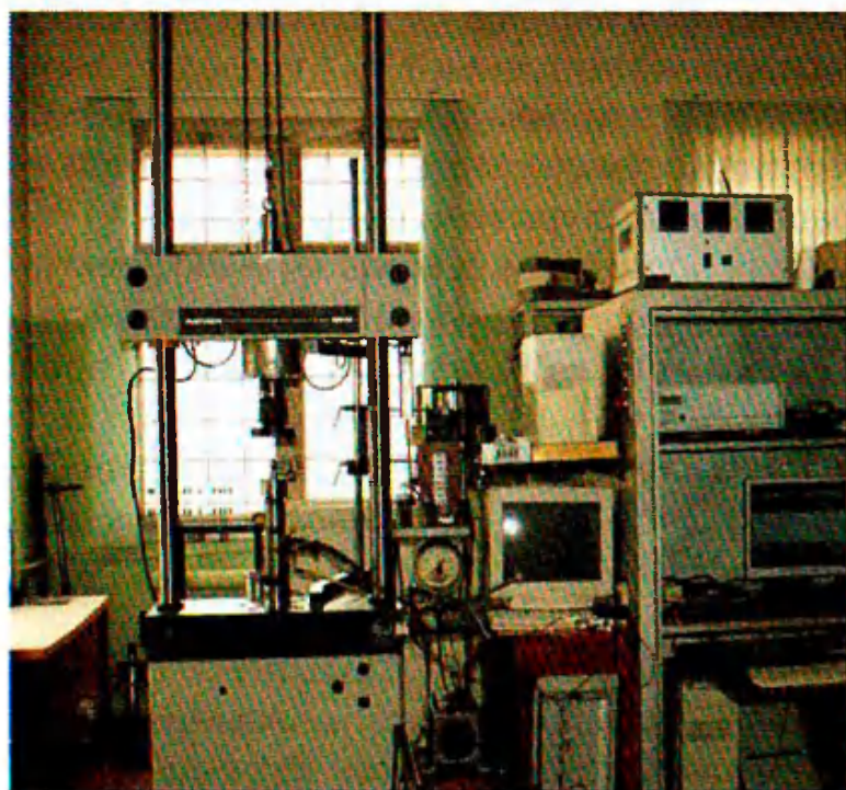
Рисунок 1 – Оборудование Отдела горного породоведения: а – пресс INSTRON 8802; б – испытание на осевое сжатие образца керна
