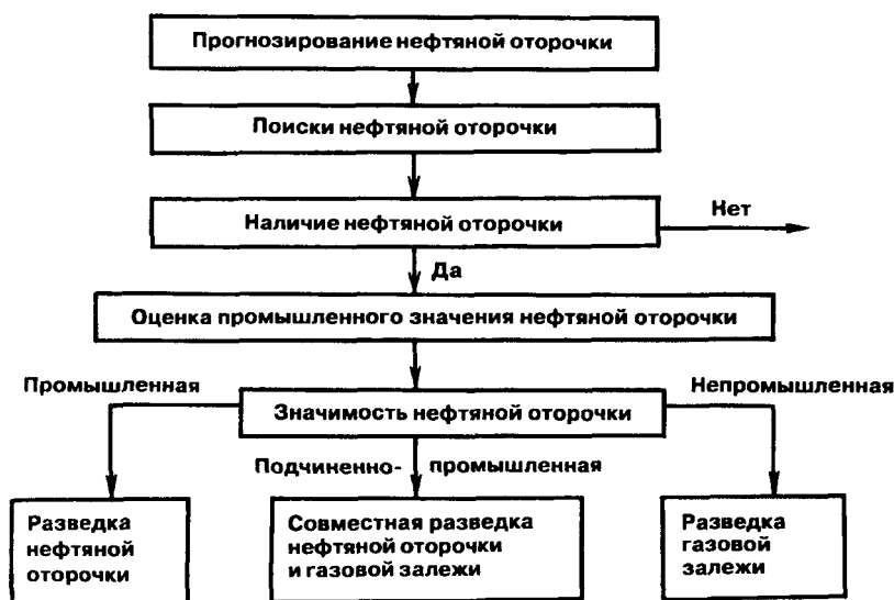
Рис. 5.3.7. Последовательность операций при разведке нефтяных оторочек газовых залежей
