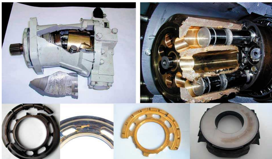
Рис. 1.59. Устройство аксиально-поршневого насоса
