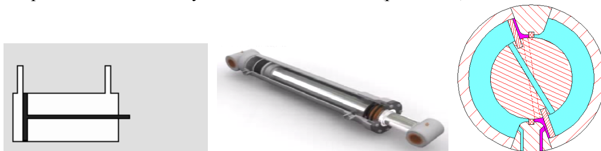
Рис.1.61. Гидродвигатель вращательного и поступательного движения
