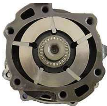
Рис.1.58. Устройство лопастного насоса
