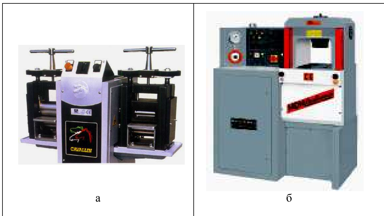
Рис.2.18. Вальцы двухсторонние с электромеханическим приводом и общий вид гидравлического прессы
