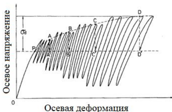
Рис. 1.19. Построение кривой «осевое напряжение-осевая деформация» по результатам испытаний на циклическое нагружение в несколько этапов (Ишихара, 2008)
