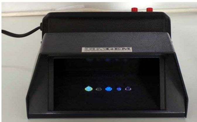
Рис. 6.3. Просмотровый бокс для наблюдения флуоресценции
