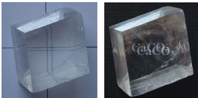
Рис. 2.1. Двулучепреломление в кристалле исландского шпата
