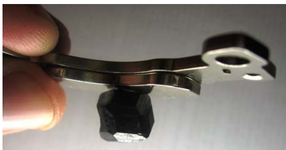
Рис. 7.2. Удержание кристалла граната неодимовым магнитом
