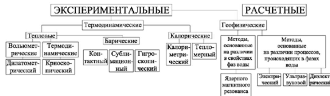
Рис. 2. Методы определения фазового состава влаги
