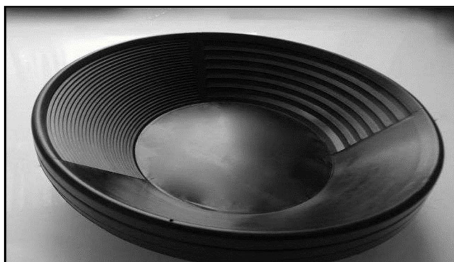
Рис. 4.4. Лоток старателя (диаметр 365 мм) Производитель – компания ALLUVIAL PACIFIC (США)
