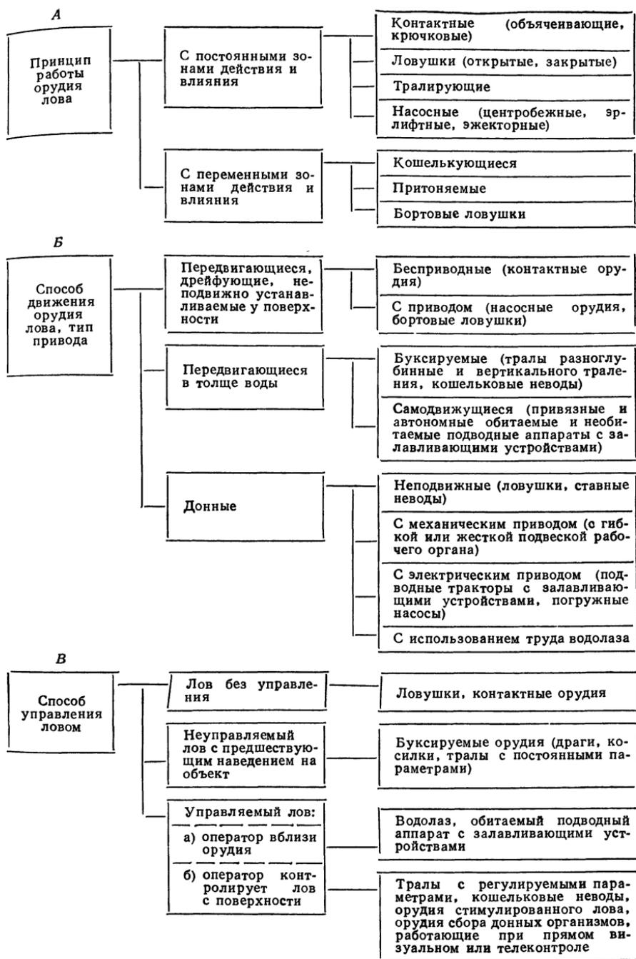
Рис. 4.4. Классификация орудий лова, выполненная на основе анализа принципа работы орудий (А), способа движения (Б) и способа управления орудиями (В).
