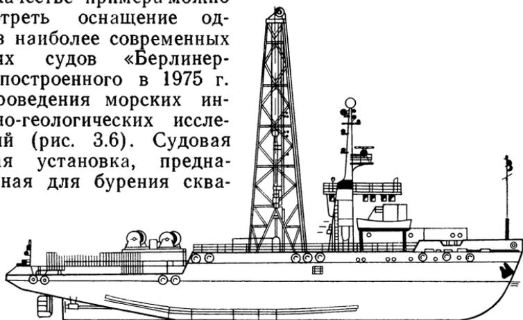
Рис. 3.6. Общий вид бурового судна «Берлинертор».
