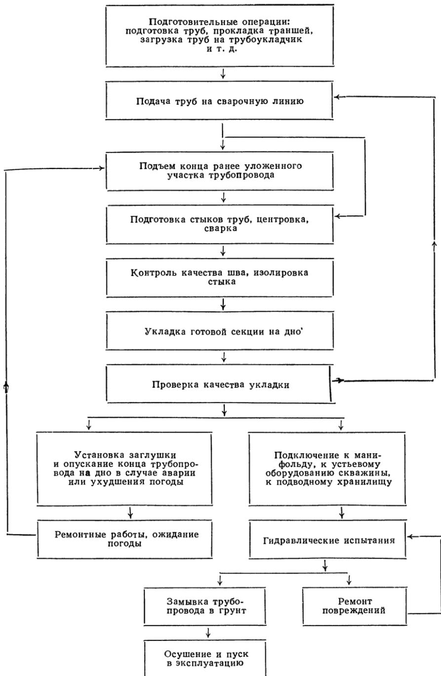
Рис. 2.11. Схема технологического процесса укладки морского трубопровода.
