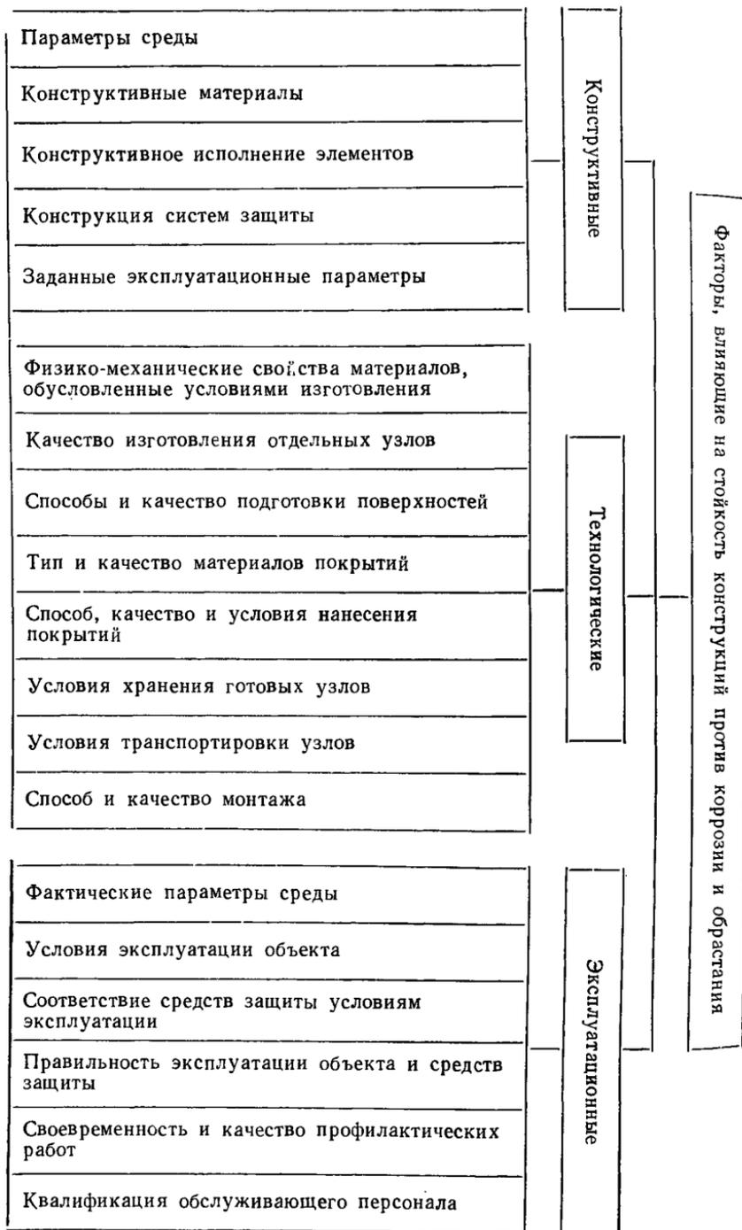
Тщательно должны отрабатываться технология нанесения покрытий и режим защиты при совместном применении необрастающих антикоррозионных покрытий и электрохимических методов защиты.
