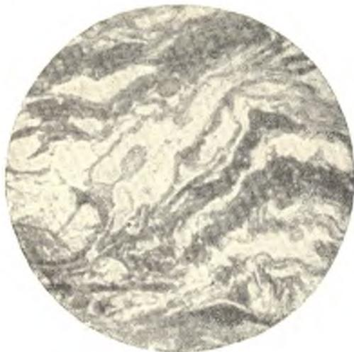
Фиг. 38. Шлиф толщины 10  $\mu$  торфа. В нижней части включения, сохранившие структуру. Препарат Лейзевица.
