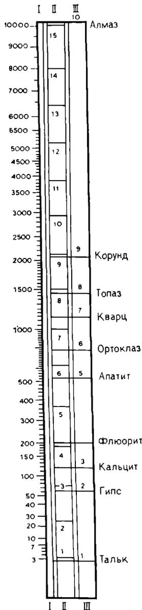
Рис. 51. Соотношение различных шкал твердости (по С. И. Лебедевой) I — абсолютная микротвердость, МПа, II — твердость, по М. М. Хрущову, III — твердость по шкале Мооса
