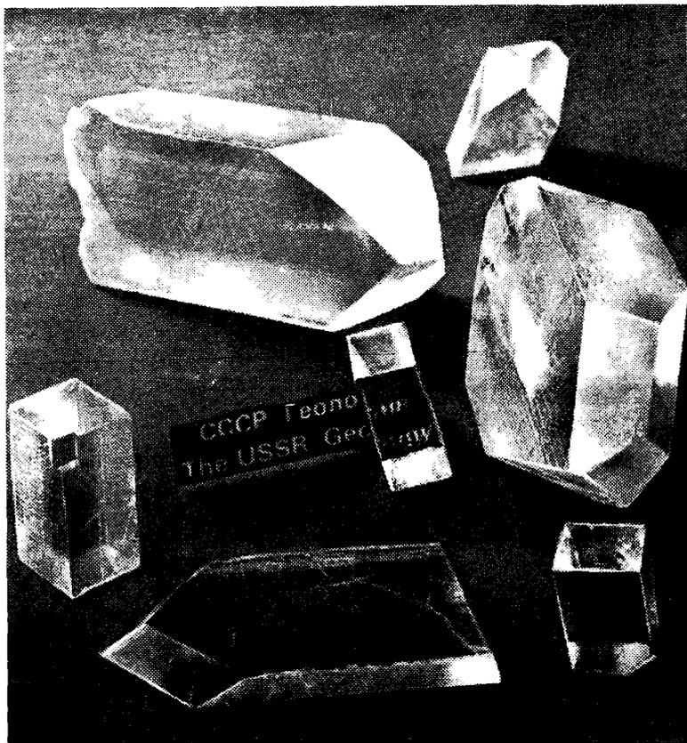
Рис. 69. Монокристаллы синтетического оптического кальцита в виде ромбоэдра и комбинации с гексагональной призмой
