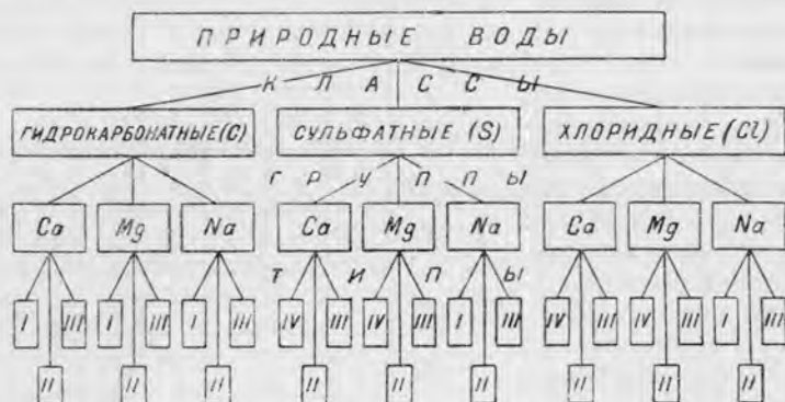
Рис. 16. Схема классификации природных вод по преобладающему аниону и катиону и соотношению между главными ионами.
