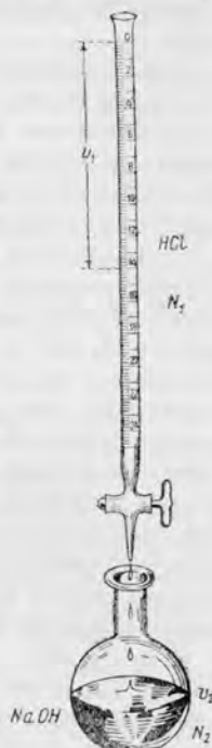
Рис. 22. Бюретка для титрования и колба с титруемым раствором.
