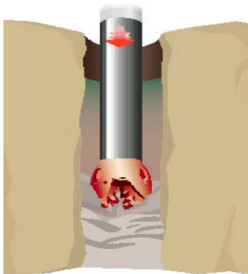
Рис. 5.21. Прихват, вызванный незатвердевшим цементным раствором
