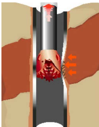
Рис. 5.4. Смятие обсадной колонны
