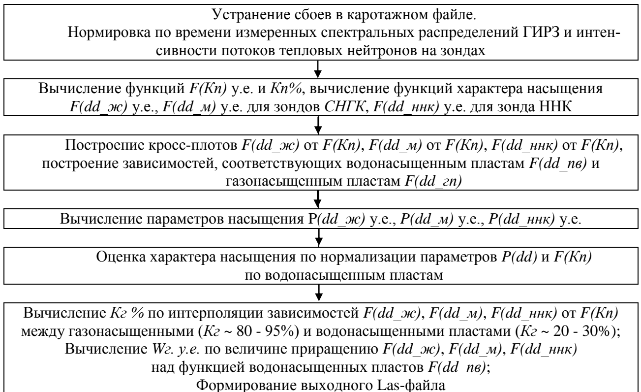
Рис. 5.1 Алгоритм обработки комплекса разноглубинных методов СНГК и ННК и вычисления коэффициента газонасыщенности Kz и объемной газонасыщенности Wz
