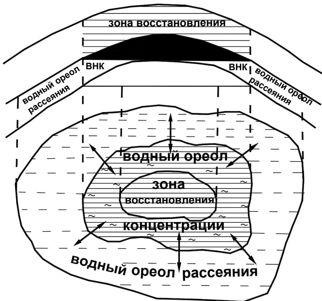
Рис.18. Схема расположения водного ореола рассеяния залежи УВ (по В. М. Матусевичу)
