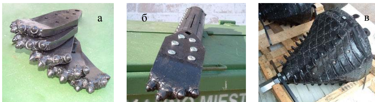
Рис. 8.2. Инструмент для горизонтального бурения фирмы Tracto Technik : а – съемные направляющие лопатки; б – буровая головка с лопаткой; в – расширитель
