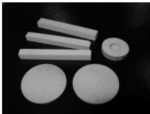
Рис. 1. Керамические образцы для механических и электрофизических испытаний.
