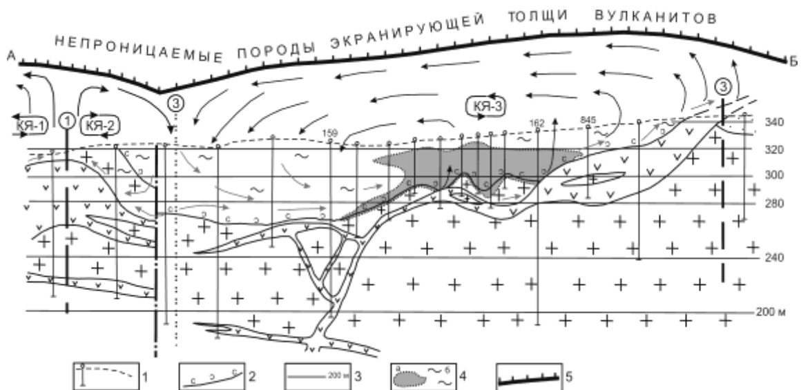
Рис. 2. Разрез по линии А-Б через северо-восточный фланг Покровского месторождения с отображением конвективных ячеек гидротермальных растворов. Условные обозначения на рисунке 1 и дополнительно: 1 — современная поверхность и вертикальные буровые скважины; 2 — подошва толщи вулканитов; 3 — горизонты месторождения с отметками (в м); 4 — контур рудной залежи (а) и ореол рассеянной прожилково-вкрапленной минерализации (б); 5 — условная поверхность непроницаемых пород экранирующей толщи вулканитов. Стрелками показаны направления движения гидротермальных растворов под экраном в трёх конвективных ячейках (КЯ). Из них западная (КЯ-1), соответствующая центральной части месторождения, показана частично.
