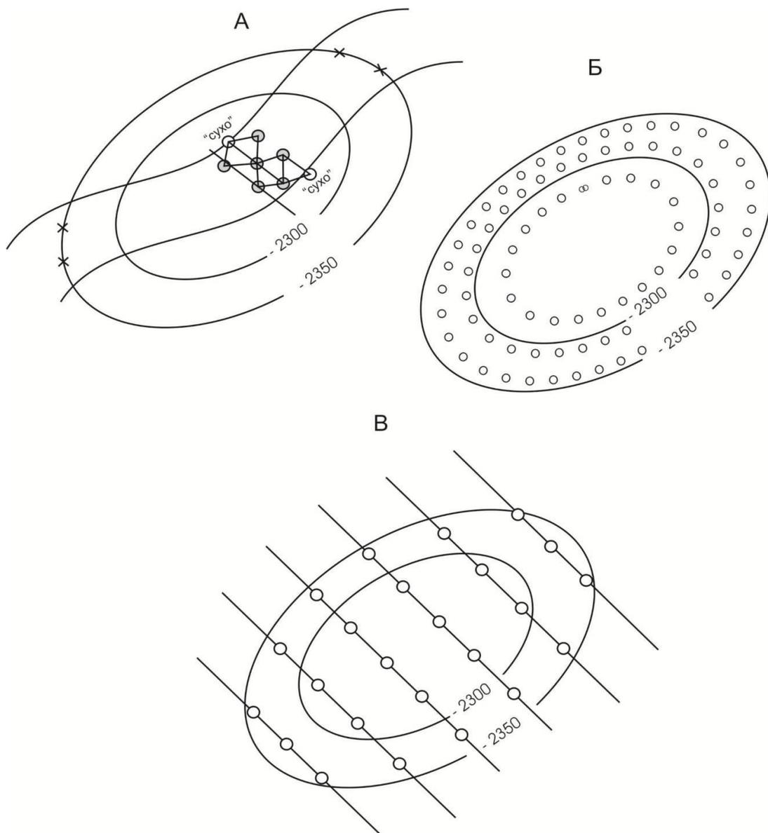
РИС. 1. СХЕМЫ РАЗМЕЩЕНИЯ РАЗВЕДОЧНЫХ СКВАЖИН
