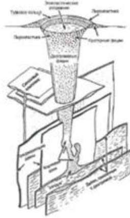
Рис. 1.9.4. Модель идеализированной магматической системы, иллюстрирующая соотношение между кратером, диафизой и гипабиссальными фациями. Последние включают силлы, дайки, корневые зоны и раздувы (рисунок из Mitchell, 1986 по Erlich and Hausel, 2006).
