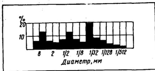
Рис. 26. Усредненный механический состав морен на основании 10 анализов (по Ф. J. Pettijohn, 1957)
