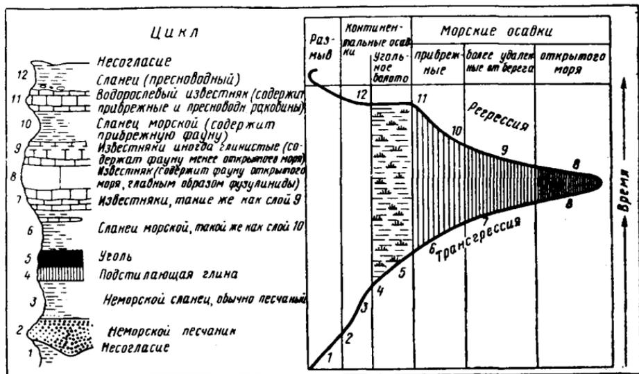
Рис. 71. Циклическая последовательность слоев каменноугольных отложений в Канзасе и их генетическое истолкование (по Р. Муру, 1953)
