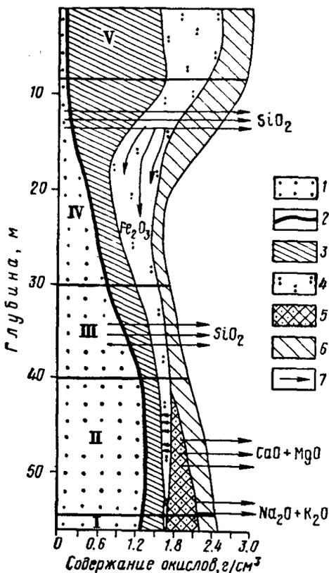
Рис. 13. Геохимическая схема тропической коры выветривания высоких пенепленов на серицит-хлоритовых сланцах. I—V—зоны профиля (по Б. М. Михайлову, 1968):
