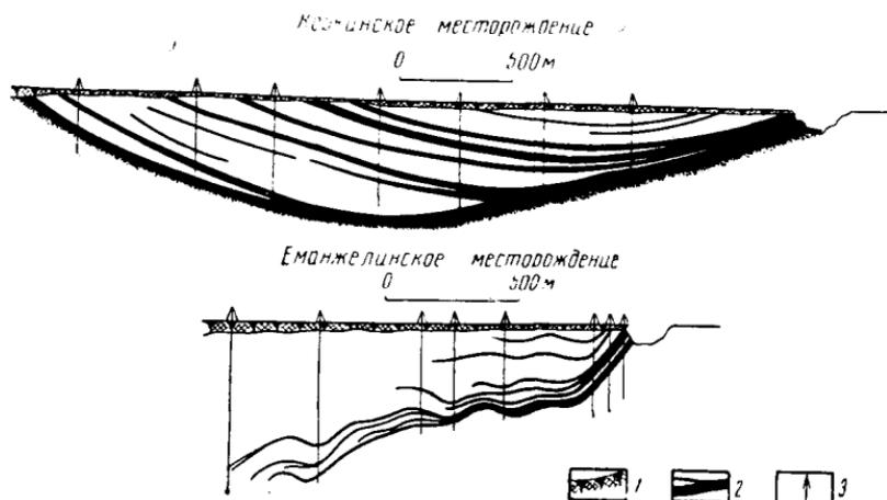
Рис. 74. Расщепление мощных угольных пластов в Коржинском и Еманжелинском месторождениях Челябинского бассейна (по Г. Ф. Крашенинникову, 1957):
