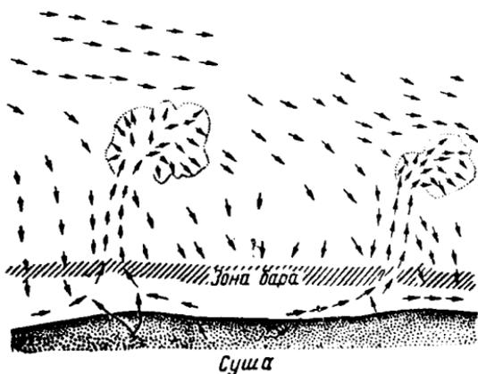
Рис. 31. Схема разрывного течения (по Ф. Шепарду, 1964)
