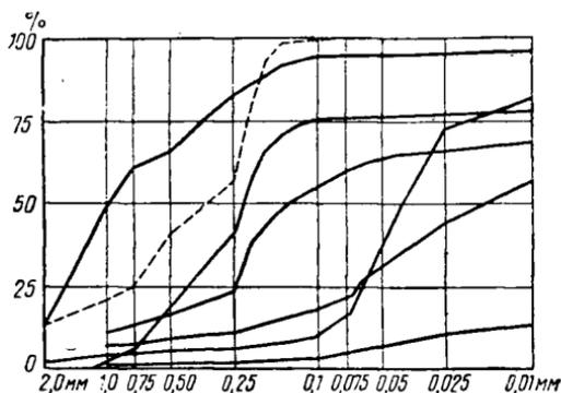
Рис. 65. Кумулятивные кривые механического состава основных типов осадков водоемов Таманского полуострова. Пунктирная линия — песок зоны морского приобья (по В. В. Веберу, 1950)
