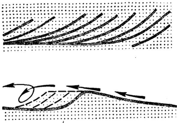
Рис. 21. Косая слоистость речного типа (вверху) и механизм ее образования (внизу)
