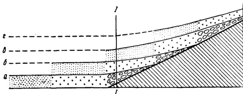
Рис. 70. Схема, поясняющая соотношения между вертикальным напластованием (по линии I—I) и сменой пород в горизонтальном направлении (по А. А. Иностранцеву, 1872); а—г — этапы опускания суши (или поднятия уровня моря)
