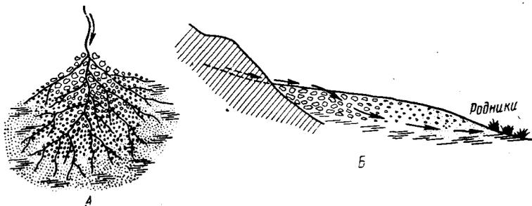
Рис. 16. Схема строения конуса выноса. А — в плане, Б — в разрезе
