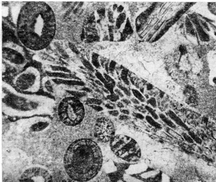
Рис. 32. Известняк органогеннообломочный мшанковый с оолитами, местами перекристаллизованный (светлые участки в микрозернистой цементирующей массе), н.—,  $\times 60$
