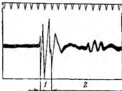
Рис. 56. Сейсмограмма одиночного взрыва:
