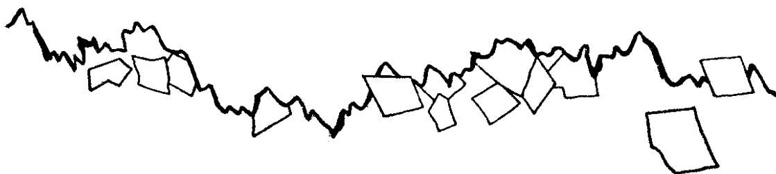
Рис 8 Развитие ромбоэдров доломита в тонко мелкозернистом известняке вдоль стилолитовой трещины Зарисовка, шлиф, \times 48
